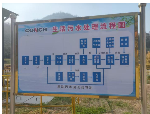
图 1-1 生活污水处理流程图
