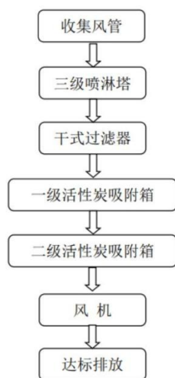
图 4-3 注液、化成废气处理流程图
