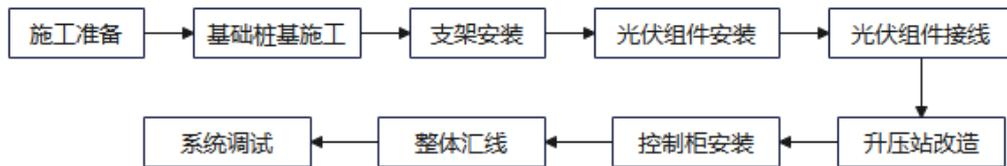
图2-7 施工期工艺流程图
