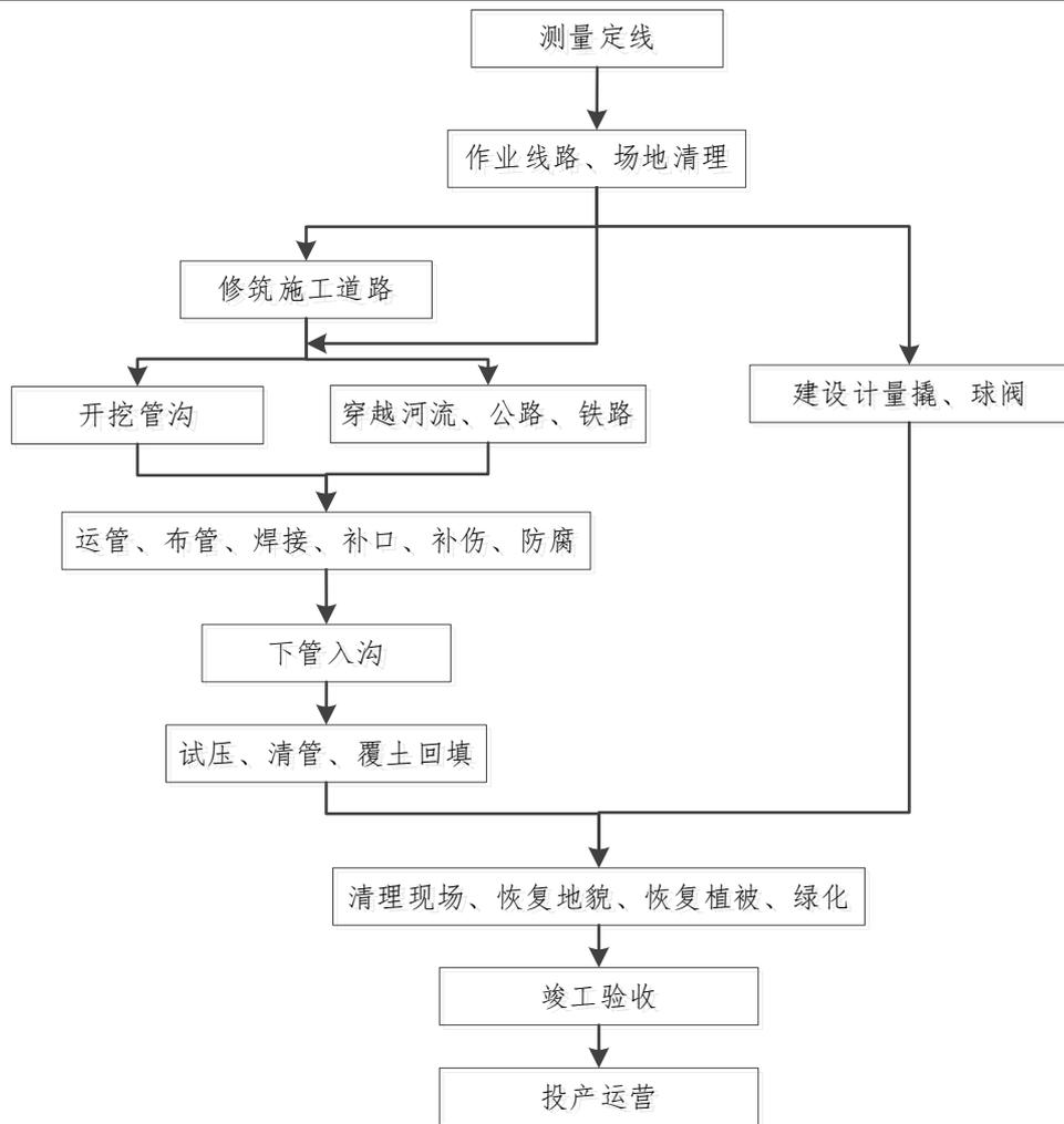
图 2-1 管道工程施工流程图
