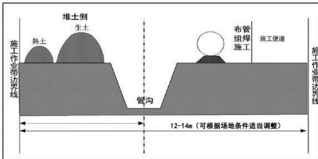
图 2-2 管沟作业带横断面布置示意图
