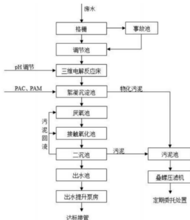
图 4-3 园区污水处理站工艺流程
