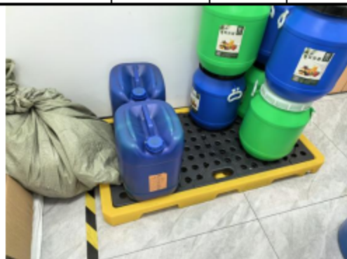
危险废物仓库防渗托盘
