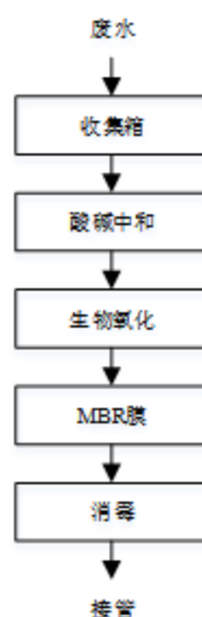
图 4-1 污水处理工艺流程图
