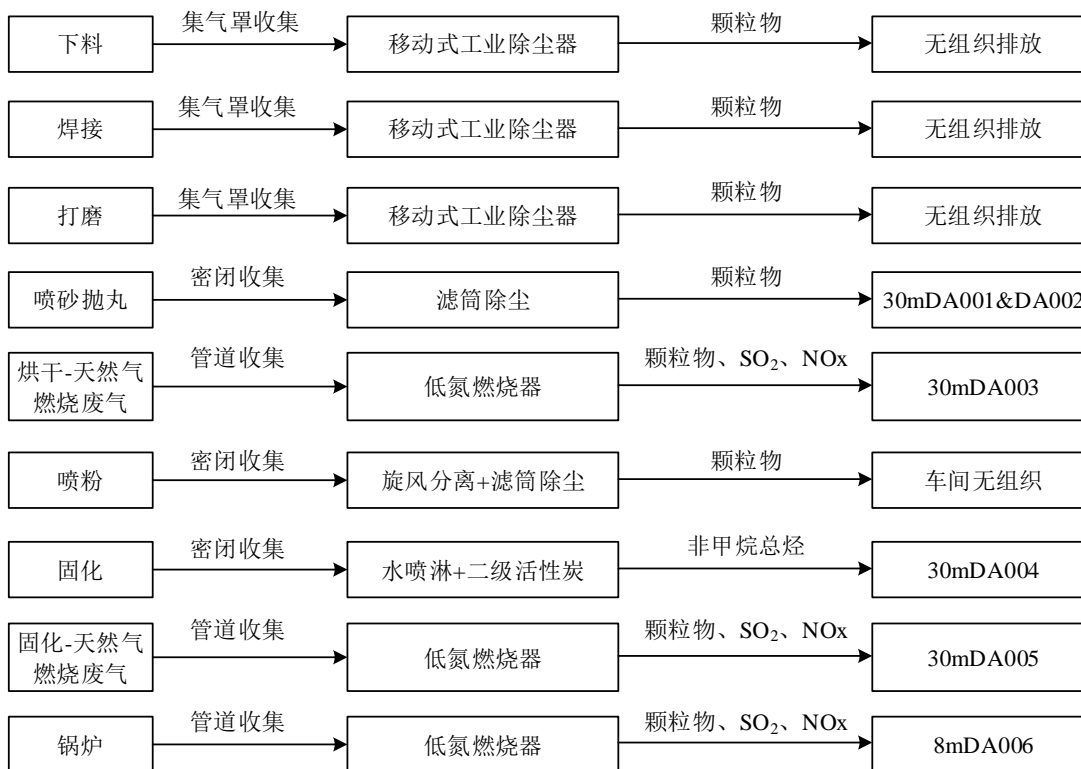
图 4-1 废气处理工艺图
