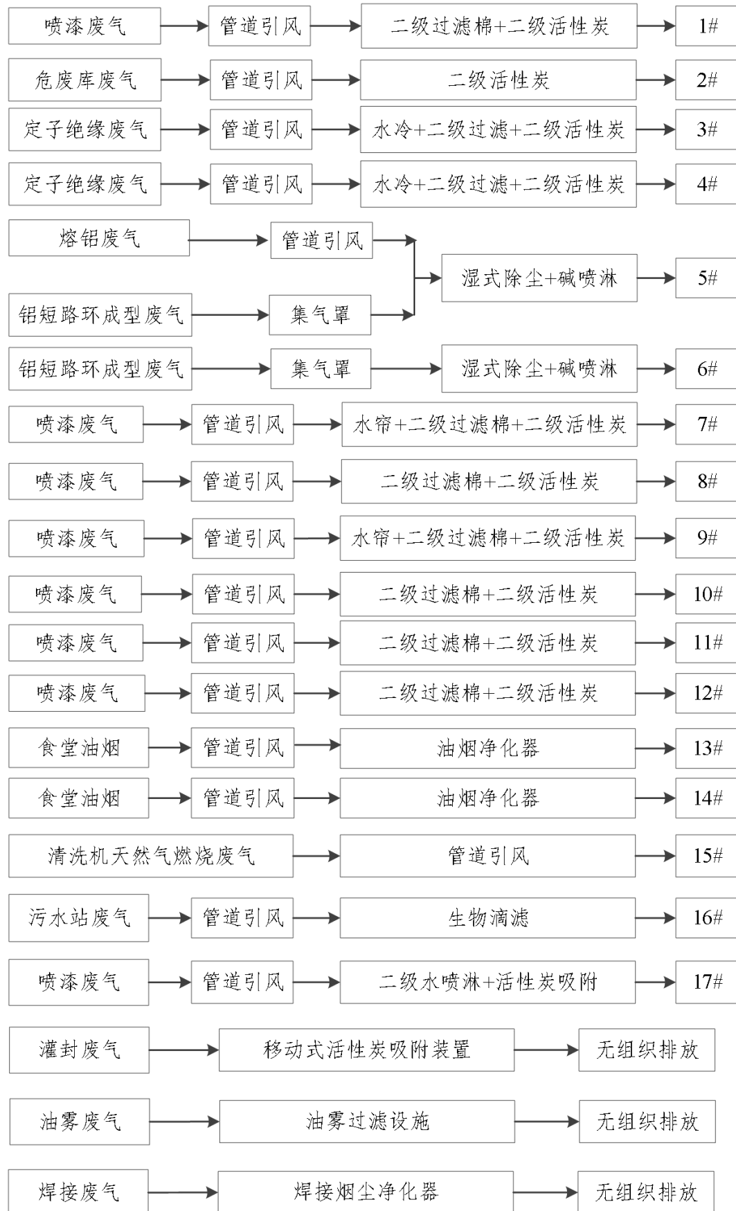
图 4.1-1 本次阶段建成后全厂废气处理流程图
