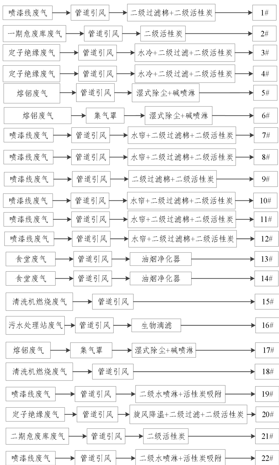
图 2.5-1 变动前全厂有组织废气处理整体流程示意图
