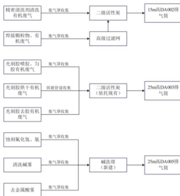
图 7 建设项目废气治理流程图
