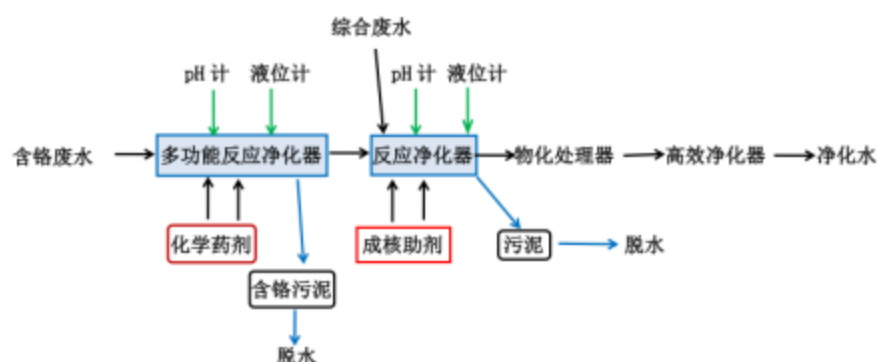
图 4 厂区污水处理站工艺流程图
